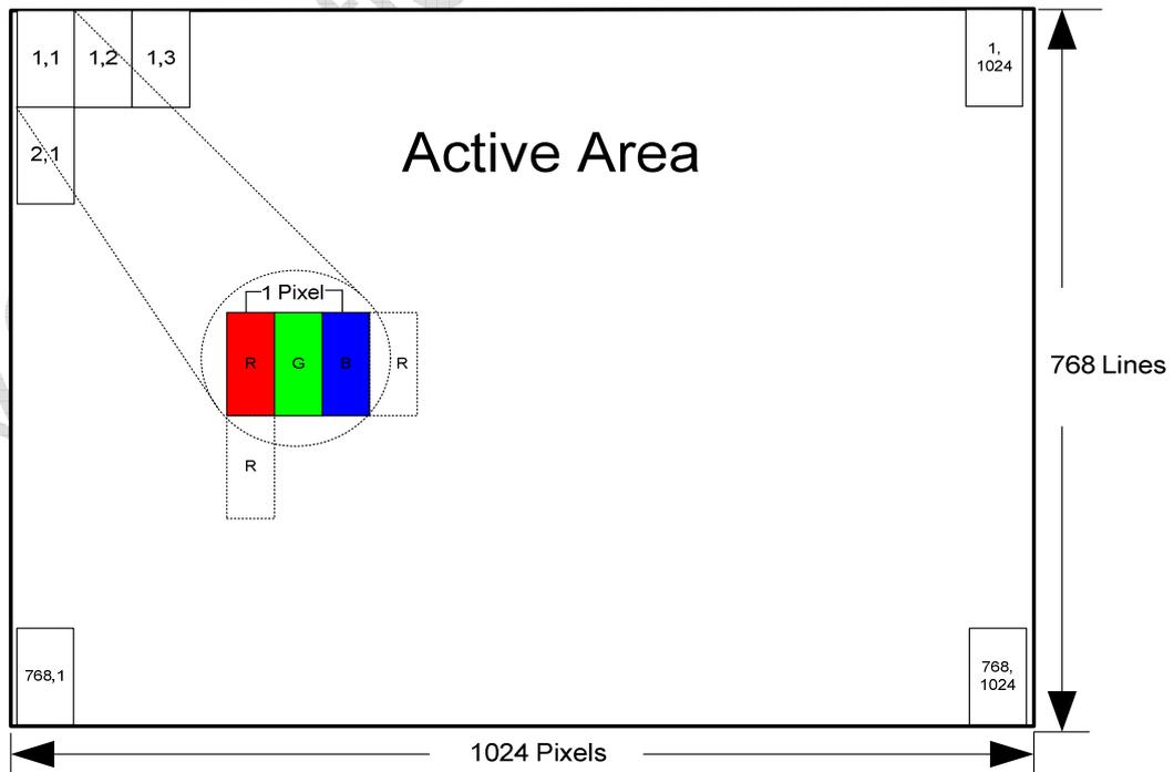
**Figure 2 Pixel Mapping**
